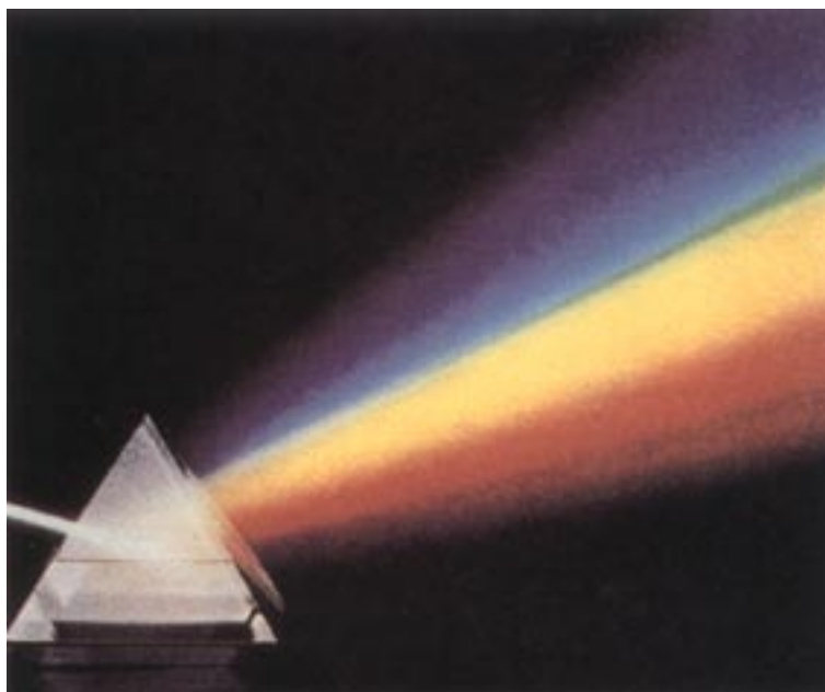
2. La dispersion de la lumière: si un rayon de lumière blanche passe par une face du prisme sous un certain angle d'incidence, on en voit sortir les couleurs, chacune étant visible séparément.
