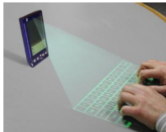
Gambar 1: Contoh desain keyboard berupa hologram sensorik yang ditampilkan dari komputer jenis mobile
